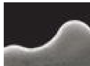
转子镀铬层1:1 Соотношение покрытия хрома во впадине и на выступе 1:1
