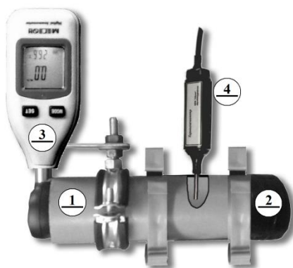
Рис. 4.2. Термоанемометр в испытательном стенде.
