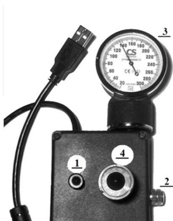
Рис. 2.3. Конструкция поверочного стенда манометра.
