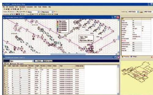
Модуль систем орошения PIPENET используется для расчета контурных трубопроводов пожарной воды. В нем можно выполнить расчеты по выбору насоса или использовать данные изготовителя насосов. В модуле есть возможность выполнить расчеты для различных случаев со сценариями пожаров, смоделировать засоры и неполадки в сети. Также можно задать регулирующие клапаны на минимальный расход.
