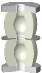
Пакет упругих элементов в разрезе
